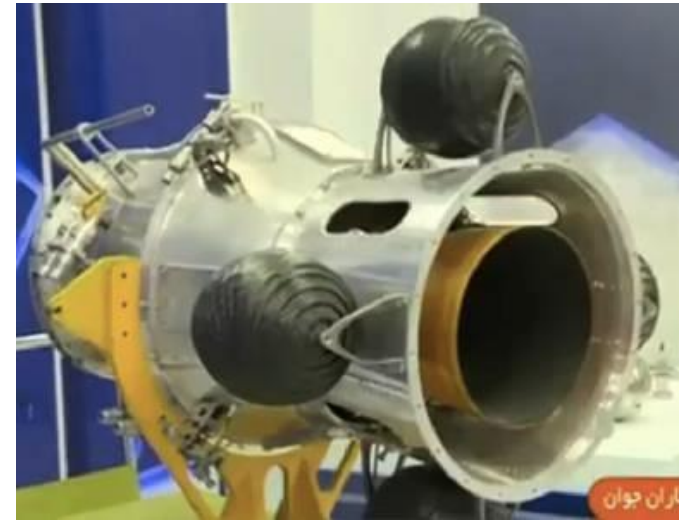
Твердопаливний двигун 3-го ступеня ракети «Саман-1»
